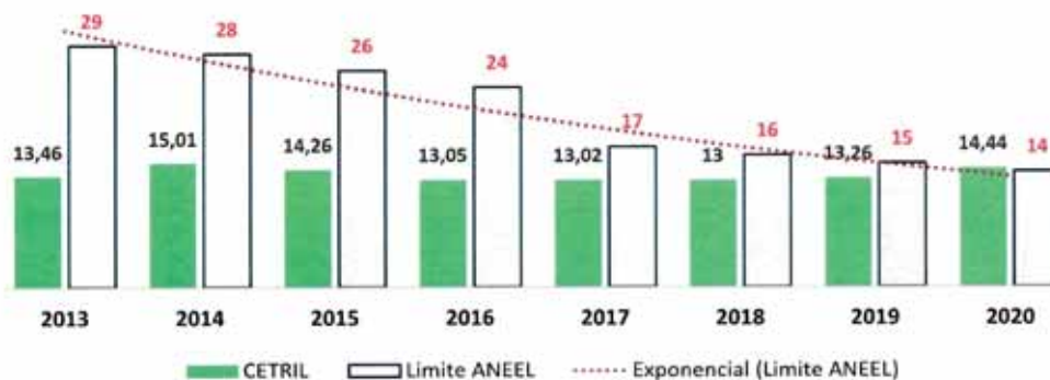
Frequência equivalente de interrupções por consumidor - FEC
