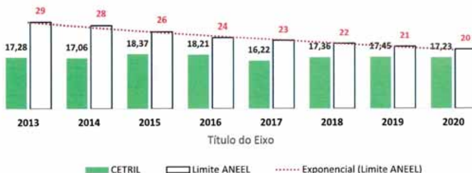
Duração equivalente de interrupções por consumidor - DEC
